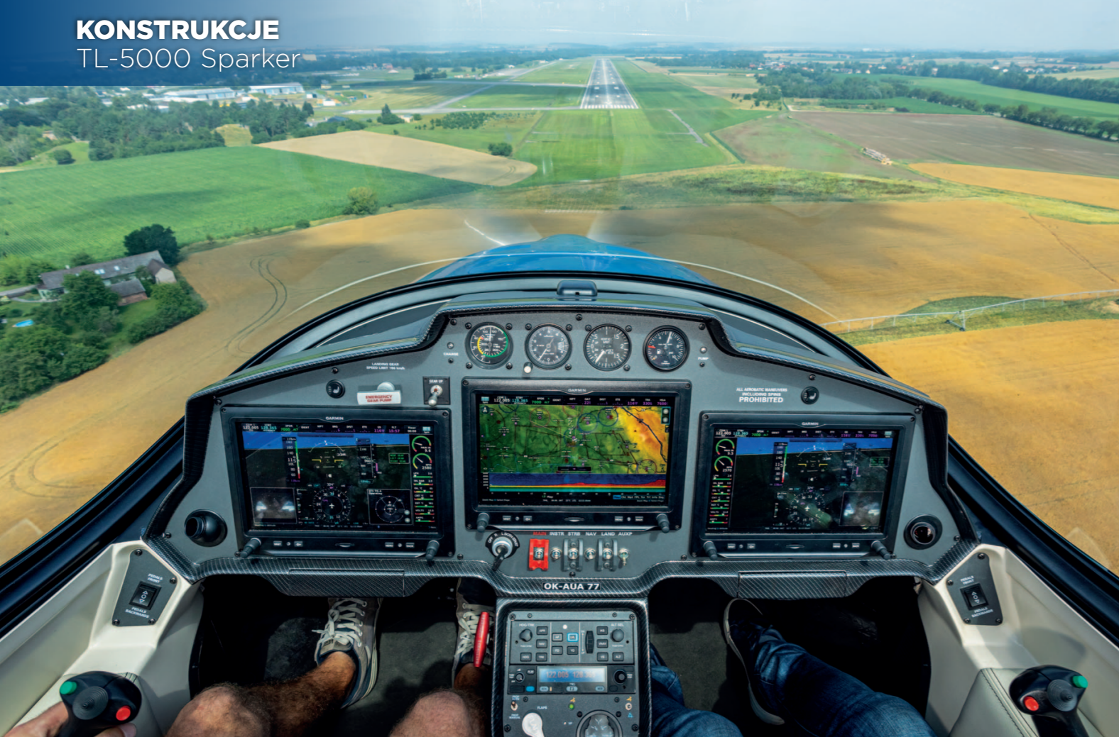
Niezawodność awioniki Garmin G3X touch zwiększona jest dodatkowo o przyrządy analogowe. O położeniu podwozia informuje nas obraz z kamery – w rogu każdego wyświetlacza
