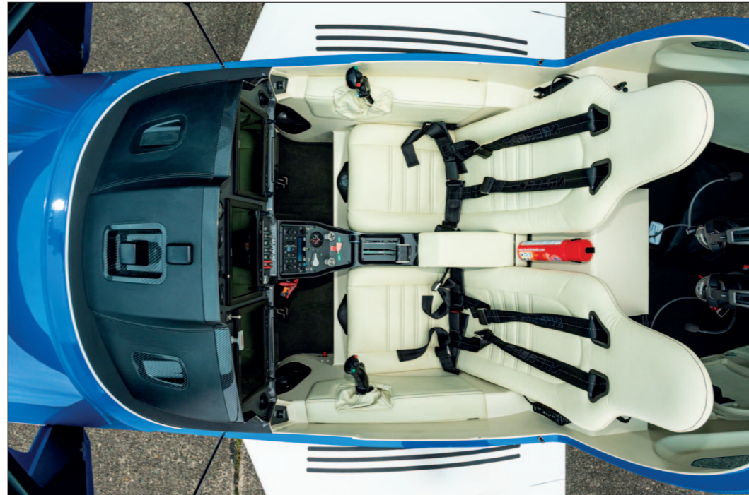
Zaletą projektu kabiny jest jej duża szerokość, a za siedzeniami duża przestrzeń na bagaż. Fotele są ogrzewane.
