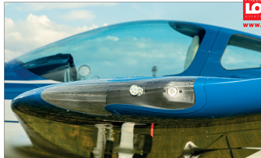
Końcówka skrzydła - ledowe światła pozycyjne i stroboskopowe mają wkomponowaną w obrys skrzydła elegancką designerską oprawę
