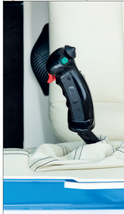
Sterownica side stick z trymerami, przyciskami nadawania i autopilota
