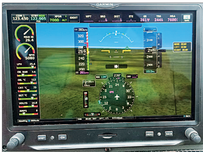
Prędkość maksymalna jest rzędu 260 km/h IAS (tu: 286 km/h TAS), przy zużyciu paliwa 25 l/h
