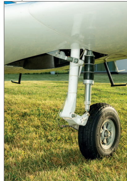
Chowane podwozie jest amortyzowane
