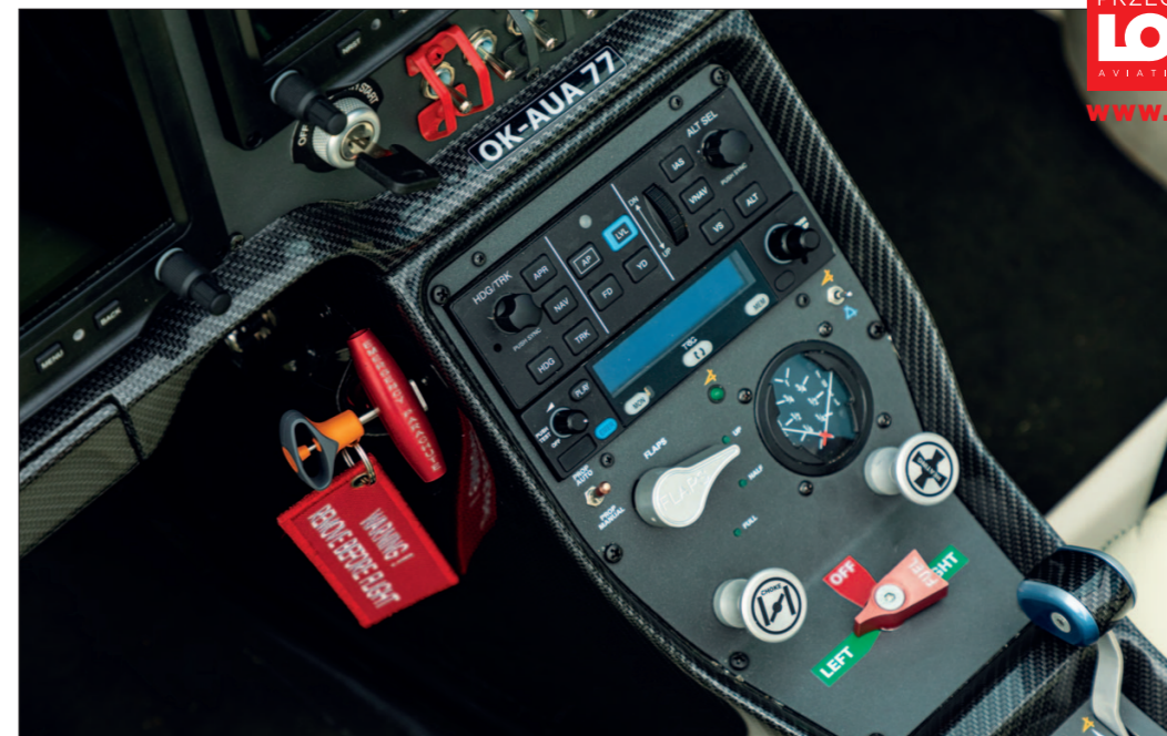
Panel centralny zawiera autopilota, radio, przełącznik klap, przełącznik trybu sterowania śmigłem, paliwomierz, ciśnno ssania i ogrzewania kabiny oraz kran paliwa. Po stronie pilota - wyzwalacz systemu ratowniczego
