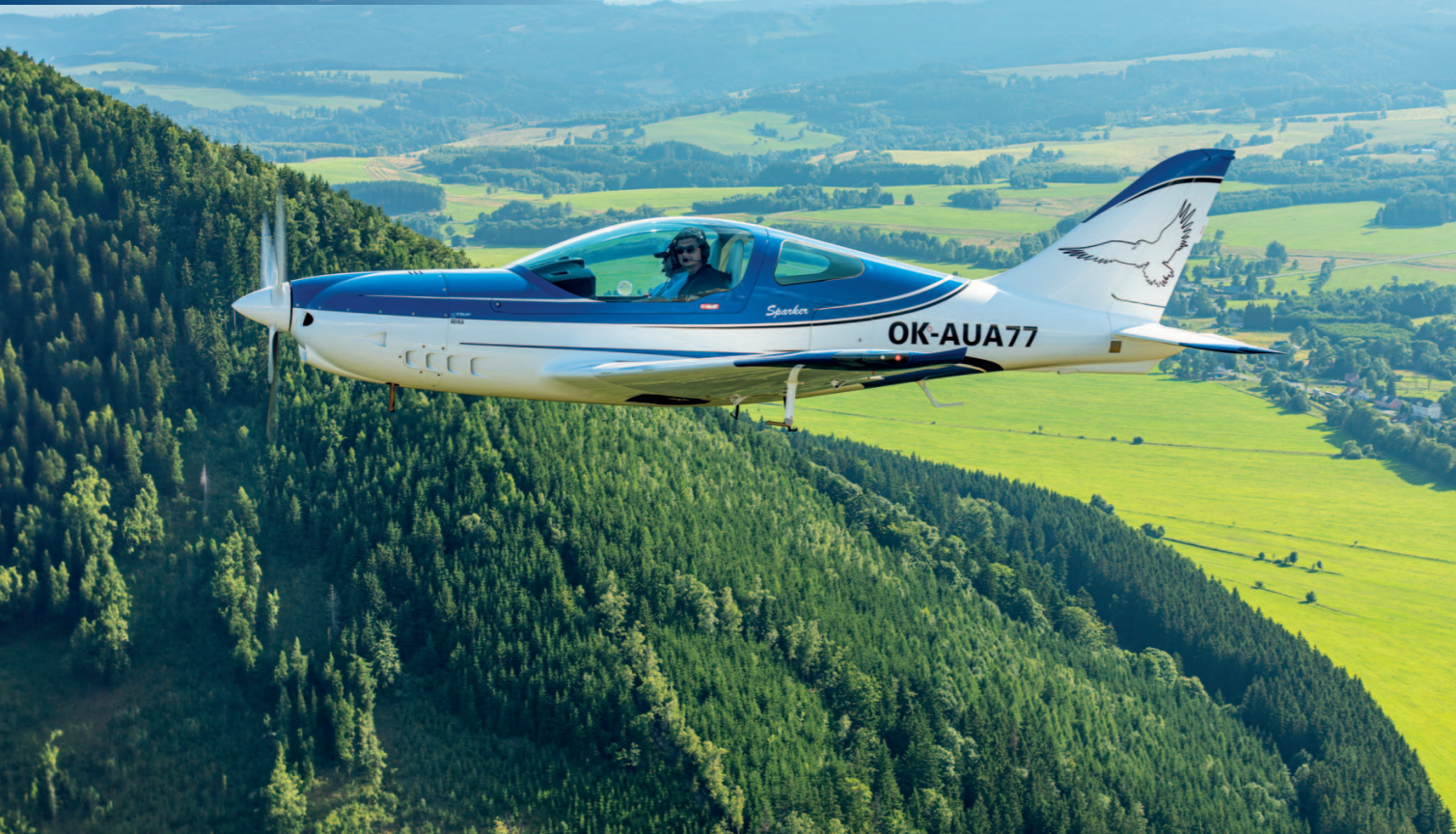
Linia samolotu i laminarny profil wyjaśniają tajemnicę osiągania dużych prędkości nawet z silnikiem o mocy 100 KM
